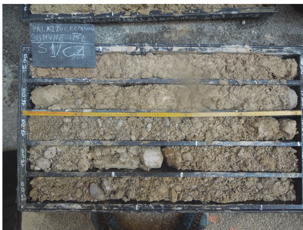
Foto n° 05. Sondaggio n° 1. Cassa n° 4 da 15,00 a 20,00 m.
