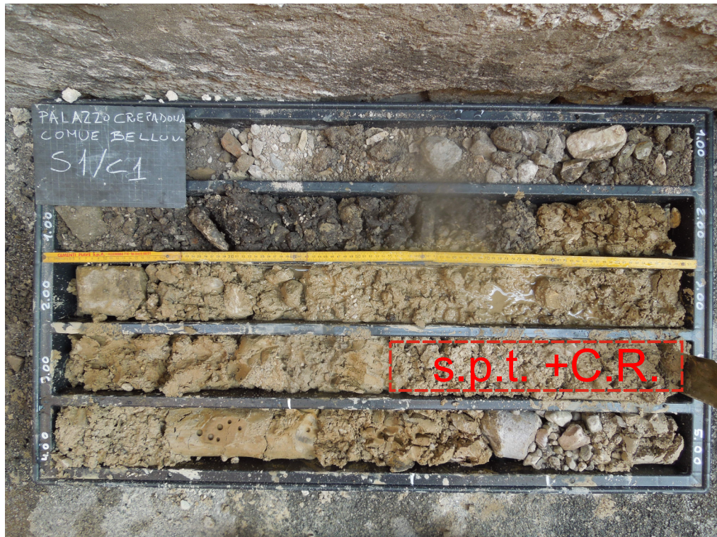
Foto n° 02. Sondaggio n° 1. Cassa n° 1 da 0,00 a 5,00 m.
