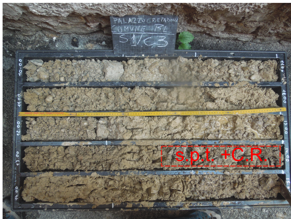
Foto n° 04. Sondaggio n° 1. Cassa n° 3 da 10,00 a 15,00 m.
