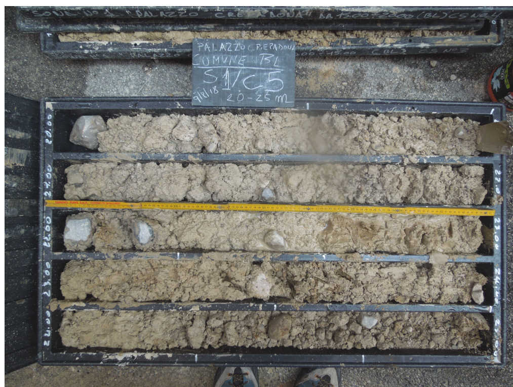
Foto n° 06. Sondaggio n° 1 Cassa n° 05 da 20,00 a 25,00 m.
